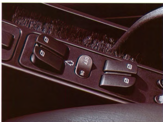
Elektrisch bediende ramen. De bediening van de ergonomisch gevormde toetsen is logisch: indrukken om de ramen open te doen en omhoog brengen om de ramen dicht te doen.
