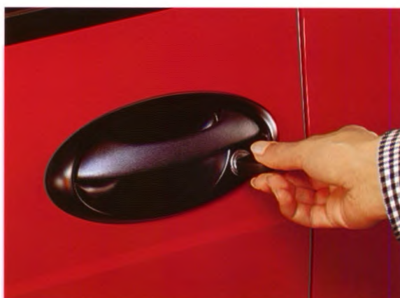
De „deadlock” functie maakt de auto moeilijk toegankelijk voor dieven. Het portier kan niet van binnenuit geopend worden, maar gaat alleen met de contactsleutel open.
