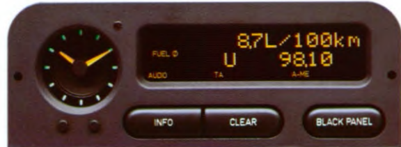
SID 2 heeft daarnaast acht controlemeldingen en twee trip-computerfuncties, t.w. gemiddeld brandstofverbruik en afstand die met de resterende brandstof afgelegd kan worden.
