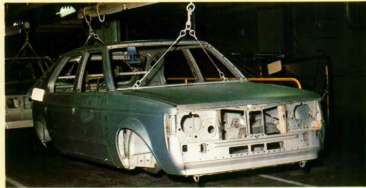
1 Plaatstaal. Panelen van de carrosserie die moeilijk te beschermen zijn, en die erg gevoelig zijn voor corrosie, worden uitgevoerd in verzinkte plaat (zinchrometaal).
