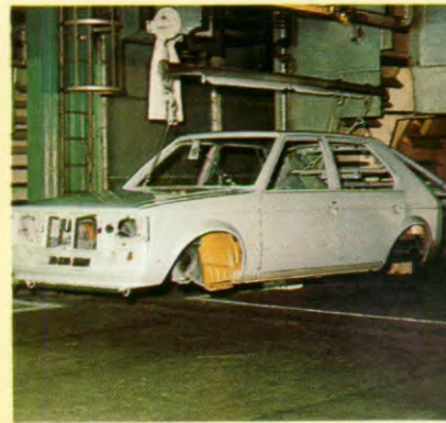
6 Grondlak. (Steunlaag voor de lak). Bevat roestwerende pigmenten (zinchromaten) ter verbetering van de roestwerende eigenschappen. Beschermst ook tegen steenslag.
