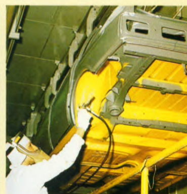
5 Ovengeharde PVC coating. Beveiligt carrosseriedelen die aan steenslag e.d. worden blootgesteld, dikte ongeveer 1 à 2 mm.
