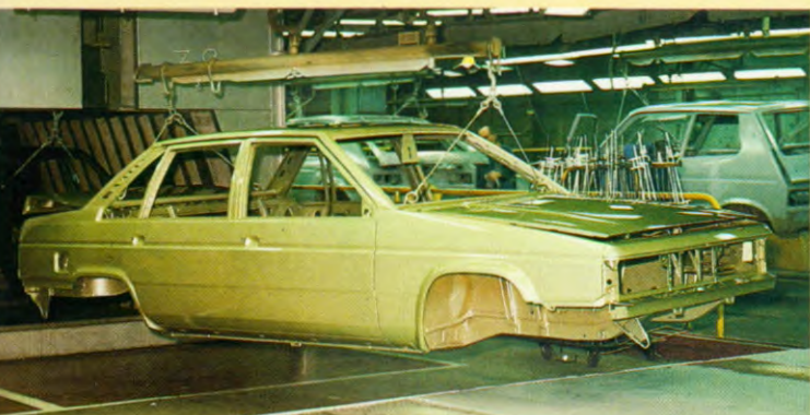
8 Vernislak. (Alleen bij Talbot's met metaallak of noir onyx). Verhoogt de glans en heeft een extra beschermende functie voor kleur- pigmentatie en tegen verwerking.
