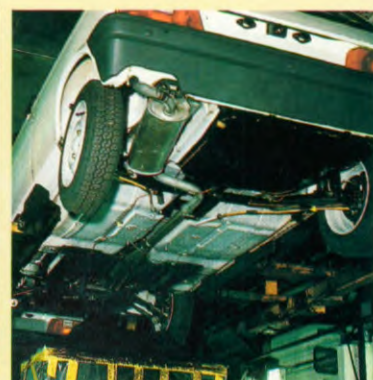
10 Undercoating op bitumenbasis. Voorkomt binnendringen van water en vocht in holle delen.
