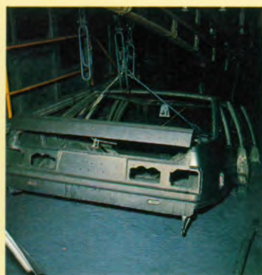
3 Kataforese. Extra beschermende laag dank zij kataforesebad, die ook via openingen de binnenkant van de holle delen bereikt.
