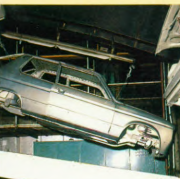
2 Behandeling met ijzerfosfaat. Beschermt tegen stoten en bladderen, verhoogt de hechting tijdens de kataforese. Sommige holle delen zijn ontvet en gefosfateerd vóór de assemblage.
