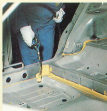
4 Mastiek. Mastiek tussen de felsnaden, zowel aan de binnen- als aan de buitenkant van de body.
