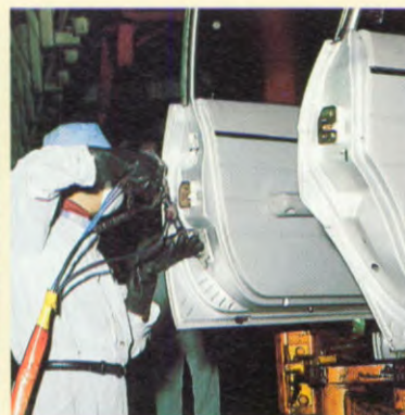
9 Wasbehandeling door drukinspuiting in holle delen. Beschermt binnenwanden en voorkomt dat water tussen de plaatverbindingen dringt.
