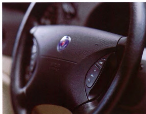
Afstandsbediening op het stuur voor de meest gebruikte functies van het audiosysteem.
