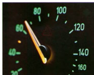
Dankzij de verkleining van de snelheidsmeter boven de 140 km/uur zijn de lagere snelheden gemakkelijker af te lezen.
