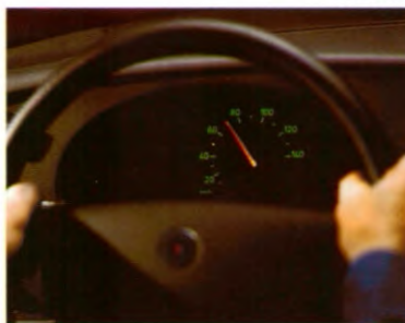
De Night Panel functie schakelt de verlichting van alle instrumenten behalve de snelheidsmeter uit.
