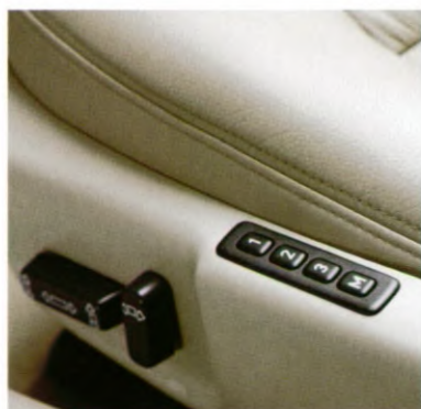
Elektrisch verstelbare voorstoelen, met de mogelijkheid van drie geheugeninstellingen aan de bestuurderskant.
