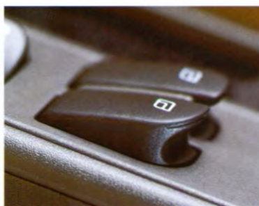
Elektrisch bediende ramen. Indrukken om de ramen te openen, omhoog brengen om de ramen dicht te doen.
