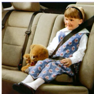
Geïntegreerd kinderzitje (voor kinderen van 3-10 jaar) is gemakkelijk uit de achterbank te klappen.
