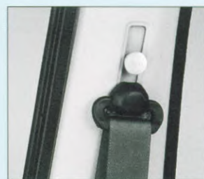
Vertically adjustable seat belt shoulder anchorage Höhenverstellbare Sicherheitsgurt-Schulterverankerung Ancrage de ceinture de siège à réglage vertical Anclaje del cinturón de seguridad a la altura del hombro ajustable verticalmente
