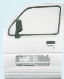
Side door impact beam Seitentür mit Seitenaufprallschutz Barre d'impact latéral dans les portes Barras laterales
