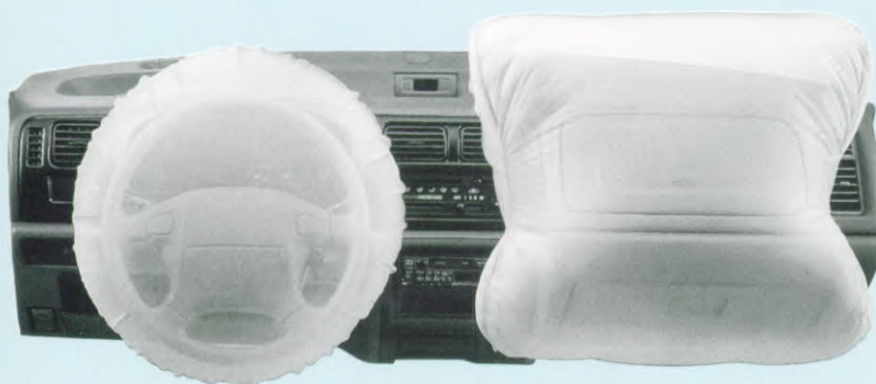
Release of air bags (composite picture) Auslösen der Airbags (zusammengesetzte Darstellung) Libération des airbags (Image composite) Disparo del airbag (ilustración compuesta)
