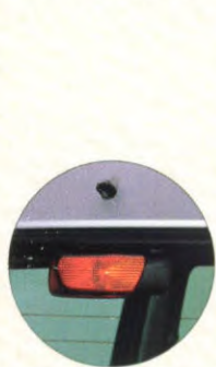
Een hoog gemonteerd derde remlicht
