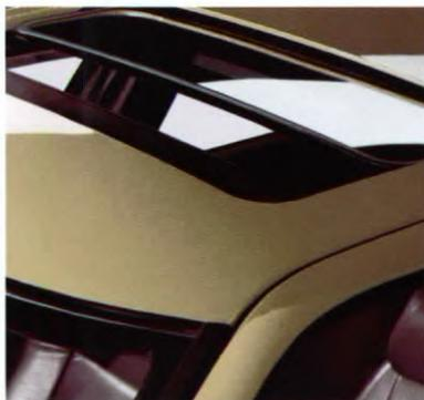
Elektrisches Glas-Hubschiebedach mit Innenblende.
