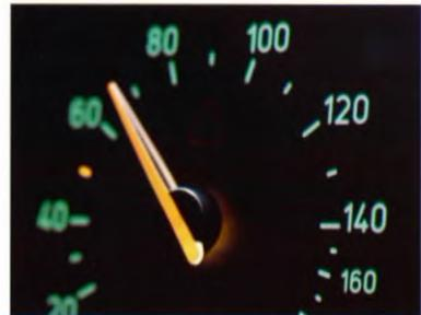
Die asymmetrisch gegliederte Geschwindigkeitsskala ermöglicht eine exaktere Temporegulation unter 140 km/h.
