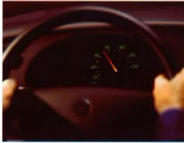
Das Night Panel blendet außer dem Tachometer alle Anzeigen aus.
