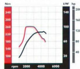
Max. Drehmoment 260 Nm bei 1900 U/min.
