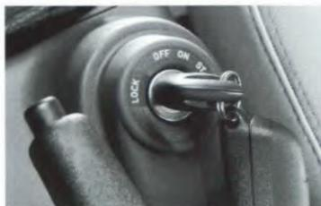
*Beim Einlegen des Rückwärtsgangs verriegelt das Zündschloß gleichzeitig das Getriebe. Die elektronische Wegfahrsperrung macht es unmöglich, das Fahrzeug ohne korrekten Schlüssel zu starten.*
