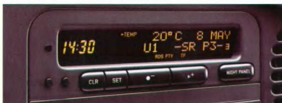
*Das SID1 informiert den Fahrer über Außentemperatur, Kraftstoffverbrauch und Reichweite. Das SID2 (Option) ist ein Bordcomputer, der den Fahrer beim Überschreiten der eingestellten Geschwindigkeit warnt und über Verbrauch bis zum Fahrtziel, geschätzte Ankunftszeit und Durchschnittsgeschwindigkeit informiert.*
