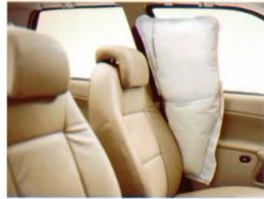
Airbags in den Außenseiten der beiden Vordersitze schützen zusätzlich bei einem Seitenaufprall.
