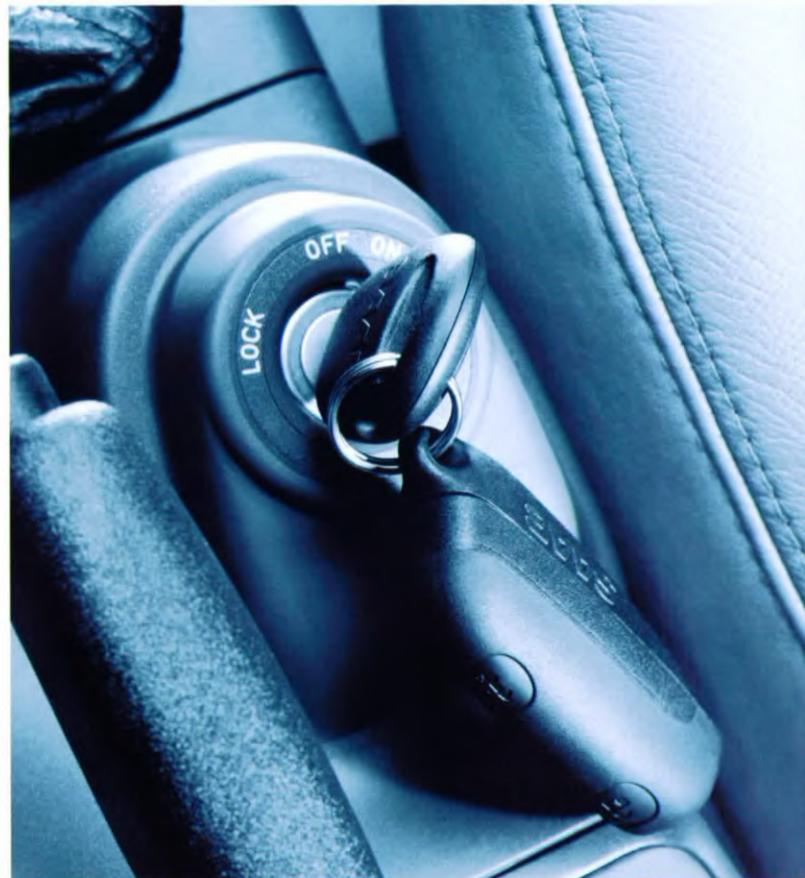
*Das Zündschloß befindet sich in der Mittelkonsole zwischen den Vordersitzen – passive Sicherheit, auf die Sie hoffentlich nie angewiesen sind. Eine fließende Bewegung genügt, um den Sicherheitsgurt anzulegen, den Zündschlüssel herumzudrehen, den ersten Gang einzulegen und die Handbremse zu lösen.*
