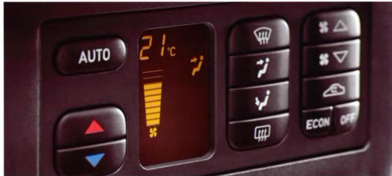
Mit der Klimatisierungsautomatik (ACC), FCKW-frei, legen Sie die Temperatur fest.
