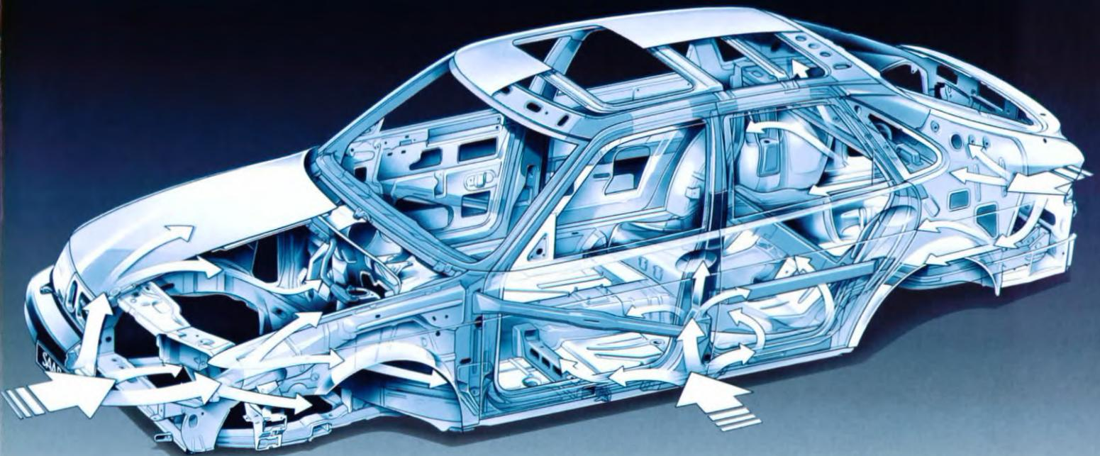
dabei, mögliche Verletzungen von Insassen zu reduzieren. Karosserieteile und starke Verstrebungen in den Türen (Flankenschutz) mit energieabsorbierendem Füllmaterial sollen dies auf vorhersehbare Art und Weise tun.
