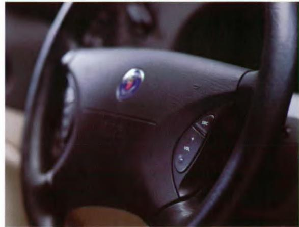
*Die wichtigsten Funktionen des Audio-Systems können über Fernbedientasten im Lenkrad gesteuert werden.*
