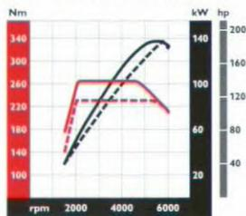
Max. Drehmoment 263 Nm bei 2100 U/min; Aut. 230 Nm bei 2000 U/min.
