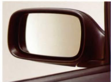
Die Außenspiegel lassen sich elektrisch verstellen und sind beheizbar. Der Spiegel auf der Fahrerseite verfügt über einen Weitwinkelbereich, der „tote“ Winkel eliminiert.
