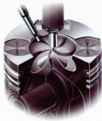
*Der Dieselmotorkraftstoff wird direkt und unter sehr hohem Druck in den oberen Teil der Verbrennungskammer gespritzt. Damit der Motor so ruhig und leise wie möglich läuft, ist der 2.2 Liter Turbodiesel-Direkteinspritzer mit Doppelausgleichswellen ausgerüstet.*
