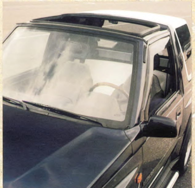
Hardtop met uitgenomen voordakdeel d.m. v. snelsluitingen
