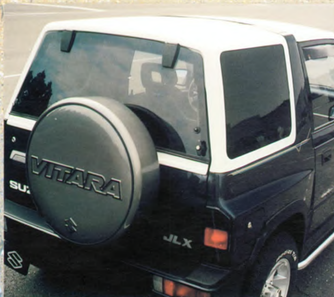
93620-62692-002 Hardtop in grijs kenteken uitvoering met geblijnde zijruiten, kleur wit, eenvoudige montage. Ook in zwart leverbaar: bestelnr. 93620-62692-001
