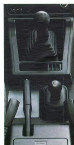
Tussenbak voor hoge en lage gearing
