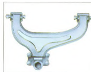
Deze reactiestang zorgt voor een optimale aslokatie
