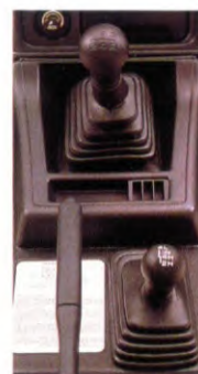
Tussenbak voor hoge en lage gearing.
