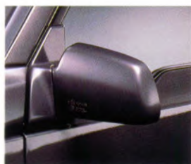
Van binnenuit elektrisch te verstelen buitenspiegels
