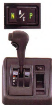
Viertraps automaat met lock-up en overdrive
