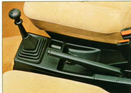
De meeste bedieningsorganen voor het starten zijn op de middenconsole geconcentreerd – het contactslot, de handrem, de versnellingspook en de vergrendeling van de veiligheidsriemen.
