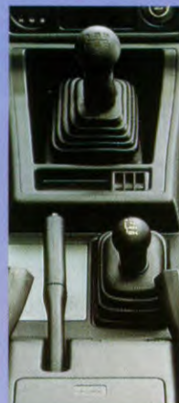
Tussenbak voor hoge en lage gearing.
