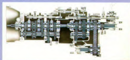
Dwarsdoorsnede van versnellingsbak en tussenbak.
