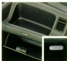
Afsluitbaar dashboardkastje met ingebouwde handgreep en daarin de ontgrendelingsknop voor de motorkap.
