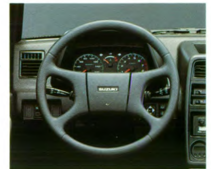
Het met een zacht materiaal beklede stuurwiel heeft vier spa-ken en is in hoogte verstelbaar.
