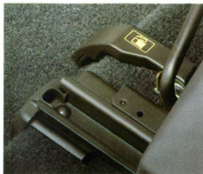
Het benzineklepje is van binnenuit te openen: geen vieze handen meer.
