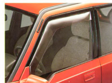
Met de windkappen kunt u ook in de regen probleemloos met geopende ramen rijden.
