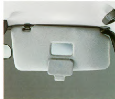
Zowel voor chauffeur als passagier is er een onneklep, die aan passagierszijde bovendien is voorzien van een make-up spiegel.
