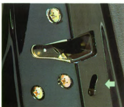
Door de kindersloten te activeren kunnen de achterportieren niet van binnenuit worden geopend.
