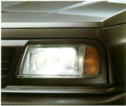
De halogeen koplampen zijn samen met de richtingaanwijzers ondergebracht in één unit.
