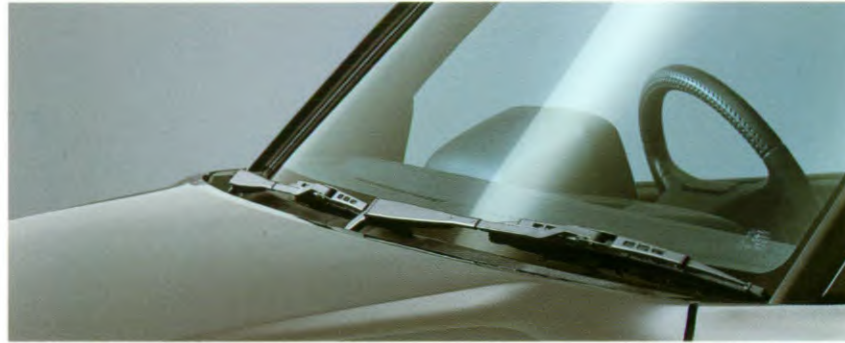
De gedeeltelijk verzonken ruitwissers (met intervalstand) verbeteren de aerodynamica geven de auto een fraaie aanblik.
