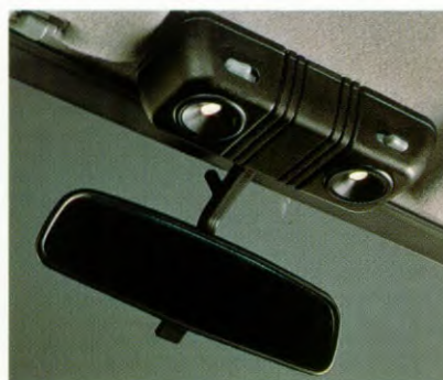
Binnenspiegel met antiverblindingsstand en twee kaartleeslampjes.
