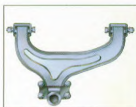
de reactiestang zorgt voor een optimale aslokatie
