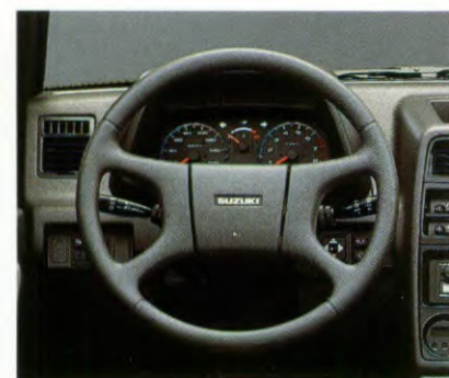
Het met een zacht materiaal beklede stuurwiel heeft vier spaken en is in hoogte verstelbaar.
