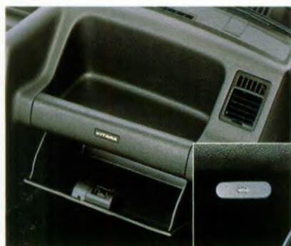
Het dashboardkastje heeft een geïntegreerde, schokabsorberende handgreep voor de passagier. De motorkapontgrendelingshendel zit uit veiligheidsoogpunt in het dashboardkastje.
