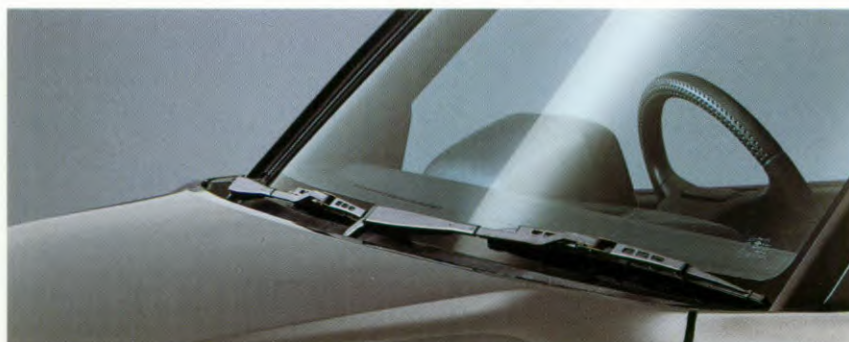
De gedeeltelijk verzonken ruitwissers (met intervalstand) verbeteren de aerodynamica en geven de auto een fraaie aanblik.
