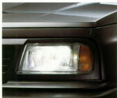
De halogeen koplampen zijn samen met de richtingaanwijzers ondergebracht in één unit.
