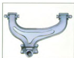
de reactiestang zorgt voor een optimale aslokatie
