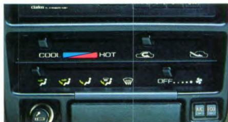
Airconditioner (extra)/ventilatie- en verwarmingssys-teem met recirculatiestand, vijf uitstroom-mogelijk-heden en aanjager met vier snelheden
