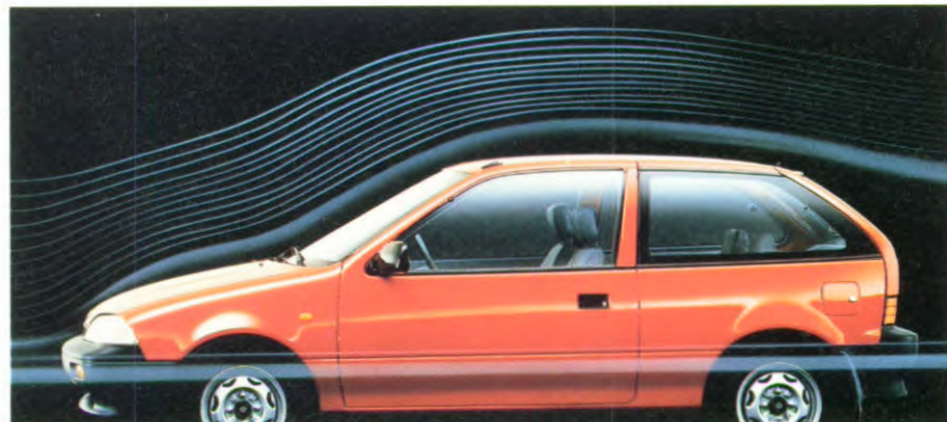
De lage luchtweerstandscoefficiënt C_w = 0,32 vermindert brandstofverbruik en windgeruis en verbetert stabiliteit bij hoge snelheden
