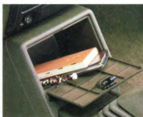
Middenconsole met twee uitklapbare bekerhouders en een opbergvak met klep
