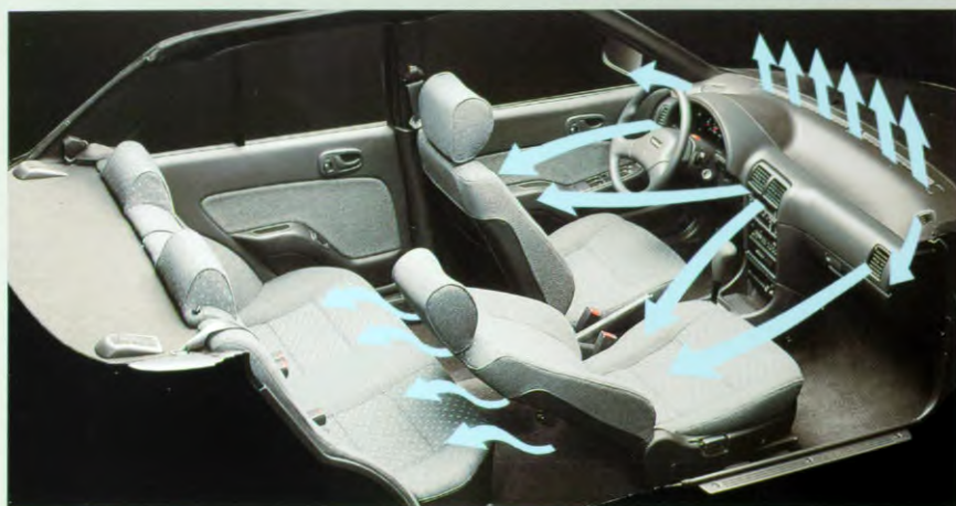
Efficiënt ventilatiesysteem met doordachte verwarming achterpassagiers
