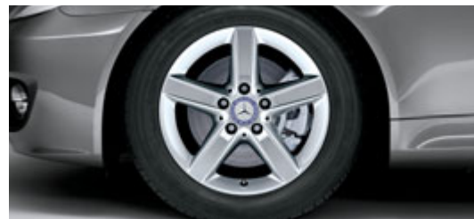
16-inch vijfspaaks lichtmetalen velg (standaard voor de SLK 280, optie voor de SLK 200 KOMPRESSOR).
