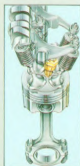
Verbrandingskamer met vier kleppen
