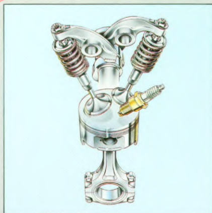
Klepbediening van de 1,3-litermotor met enkele bovenliggende nokkenas
