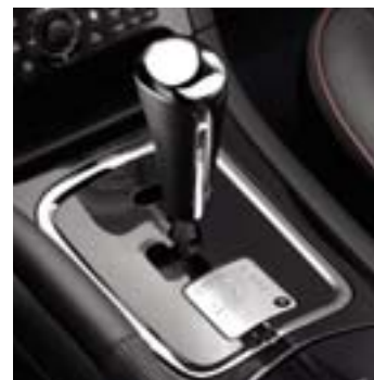
Automatische transmissie met zes versnellingen.
