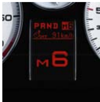
De ingeschakelde versnelling wordt weergegeven op het matrixdisplay.
