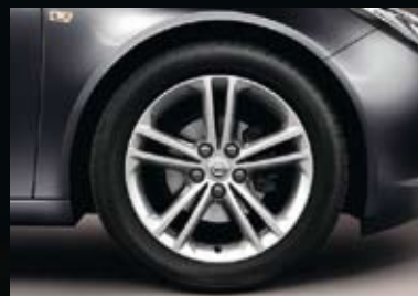
3 Lichtmetalen velg 8 J x 18, 5 dubbele spaken, bandmaat 245/45 R 18 (Q02).
