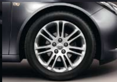
5 Lichtmetalen velg 8 J x 18, 7 dubbele spaken, bandmaat 245/45 R 18 (Q60).
