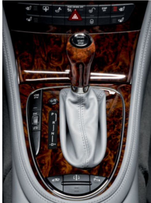
De start-/stopknop voor het als optie leverbare KEYLESS GO bevindt zich op de keuzehendel.
