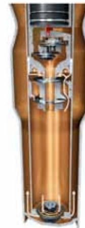
werkzuiger en bypass – bij sportief/comfortabele instelling
