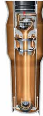
werkzuiger en bypass – bij sportief/comfortabele instelling
