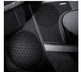
8,0 cm Neodym middentonenluidspreker en 20,0 cm Nd® lagetonenluidspreker*
