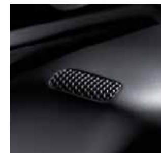
Microfoon voor AudioPilot® op de stuurkolom
