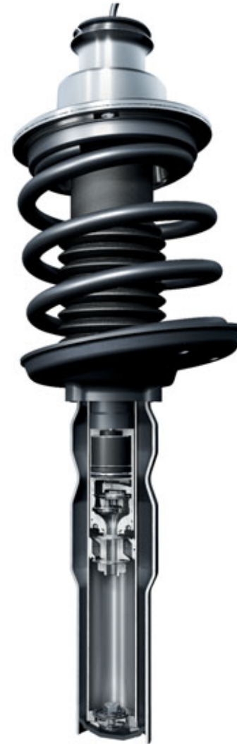
werkzuiger en bypass – bij sportief/comfortabele instelling
