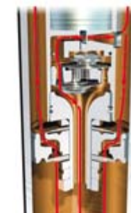
Trekfase – werkzuiger en bypass – bij sportief/comfortabele instelling
