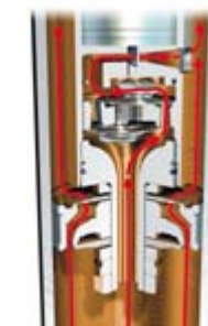
Drukfase – werkzuiger en bypass – bij sportief/comfortabele instelling
