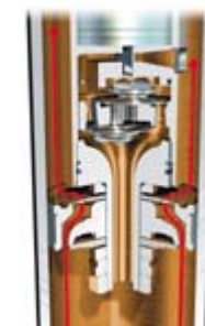
Drukfase – alleen werkzuiger – bij sportief/strakke instelling
