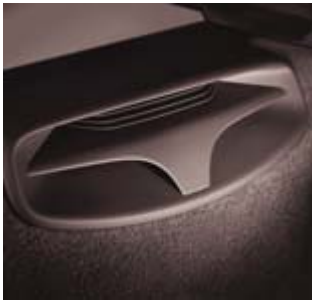
Lagetonenluidspreker van 10,2 cm x 15,3 cm in een 6-liter basreflexkast
