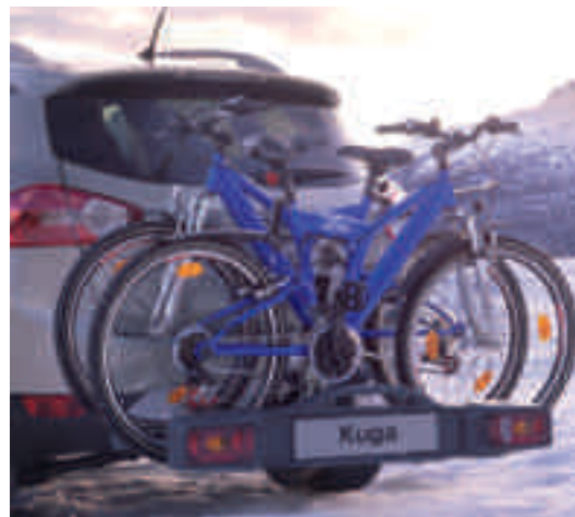
Twinny Load fietsdrager “Swing CK” Veilige bevestiging voor twee fietsen (uitbreiding mogelijk voor derde fiets) met kantelmechanisme voor eenvoudige toegang tot de kofferbak. (accessoire 1541941)
