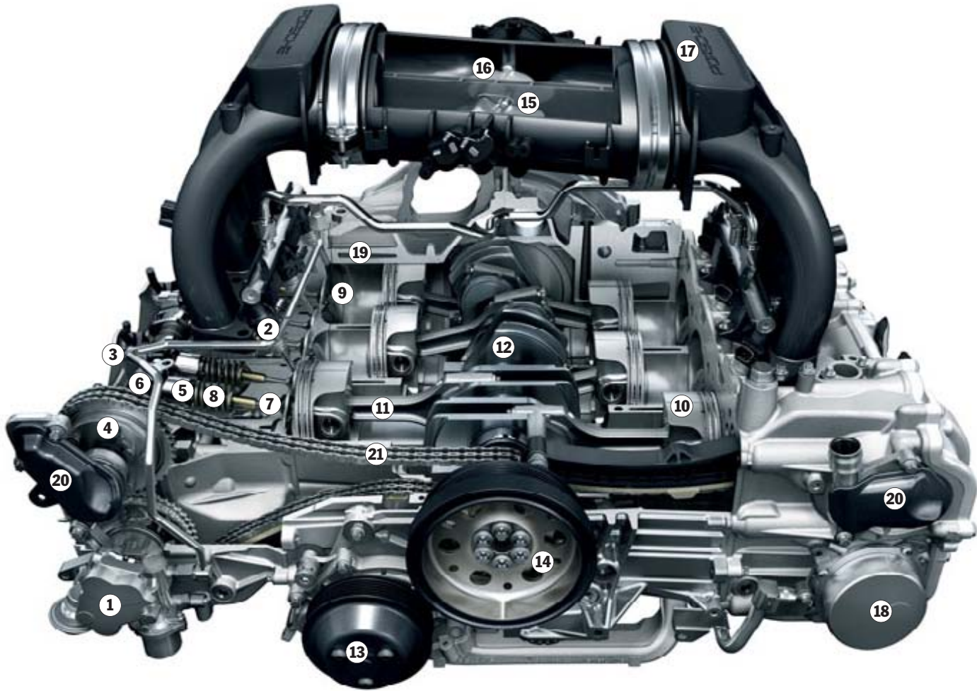
De 3,4 liter 6-cilinder boxermotor van de Boxster S
