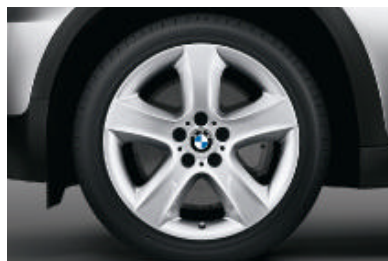
Lichtmetalen BMW wielen in sterspaak styling 212 , 9 J x 19 inch; bandenmaat 255/50 R 19 (banden met noodloopeigenschappen).
