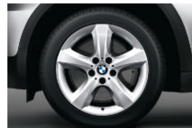
Lichtmetalen BMW wielen in sterspaak styling 210 , 8,5 J x 18 inch; bandenmaat 255/55 R 18 (banden met noodloopeigenschappen).
