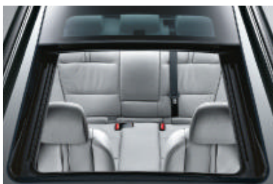
Glazen panoramadak met grote opening (0,65 m 2 ) en snelheidsafhankelijke windgeleider, elektrisch bediend, met schuif- en kantelfunctie via tiptoets, elektrische binnenhemel (zonwering), alsmede inklembeveiliging en comfortopening/-sluiting.
