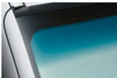
Extra warmtewerende voorruit: reduceert, door middel van een infrarood-reflecterende laag, onaangename verwarming van het interieur; de groene baan bovenin de ruit verhindert directe verblinding door zonlicht.
