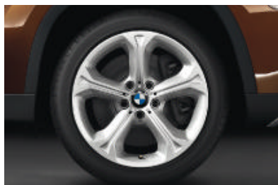
Lichtmetalen BMW wielen in sterspaak styling 320 , 8 J x 18 inch, bandenmaat 225/45 R 18. Banden met noodloopeigenschappen.
