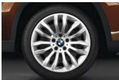
Lichtmetalen BMW wielen in dubbel-spaak styling 321 , 8 J x 18 inch, bandenmaat 225/45 R 18. Banden met noodloopeigenschappen.
