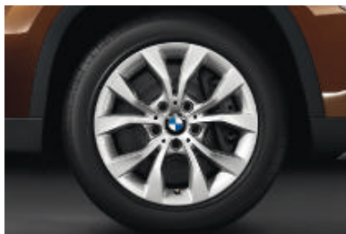
Lichtmetalen BMW wielen in V-spaak styling 318 , 7,5 J x 17 inch, bandenmaat 225/50 R 17. Banden met noodloopeigenschappen.
