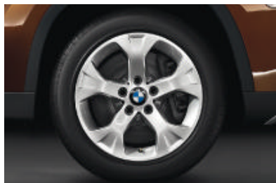
Lichtmetalen BMW wielen in sterspaak styling 317 , 7,5 J x 17 inch, bandenmaat 225/50 R 17. Banden met noodloopeigenschappen.
