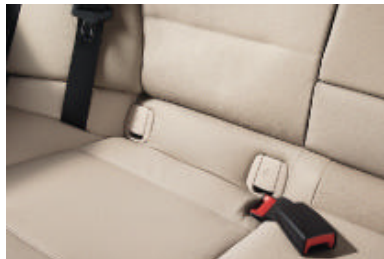
Kinderzitjesbevestiging ISOFIX , aan de buitenste achterzetels (aan voorpassagierszetel optioneel). Voor de veilige bevestiging van kinderzitjes d.m.v. kliksluitingen. Inclusief extra bevestigingspunten aan de bovenzijde. Deactiveringsmogelijkheid voor voorpassagiersairbag.
