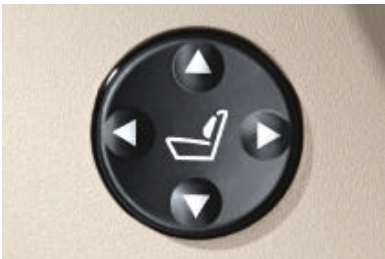
Lendensteun , voor bestuurders- en voorpassagierszetel; elektrisch in hoogte en dikte verstelbaar, voor een ergonomisch perfecte zitpositie en ter ondersteuning van de rugspieren.
