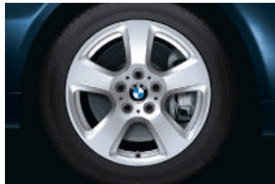
Lichtmetalen BMW wielen in sterspaak styling 243 , 7,5 J x 17 inch, bandenmaat 225/50 R 17.
