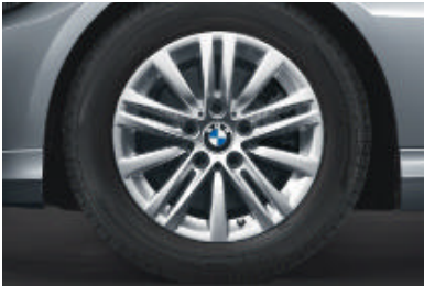
Lichtmetalen BMW wielen in sterspaak styling 283 , met noodloopeigenschappen, 7 J x 16 inch, bandenmaat 225/50 R 16.
