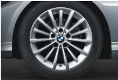
Lichtmetalen BMW wielen in multispaak styling 284 , met noodloopeigenschappen, 8 J x 17 inch, bandenmaat 225/45 R 17.
