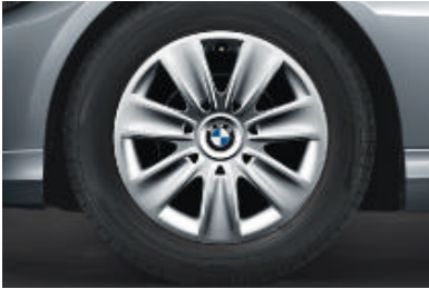
Stalen wielen met wielplaat , met noodloopeigenschappen, 7 J x 16 inch, bandenmaat 205/55 R 16.
