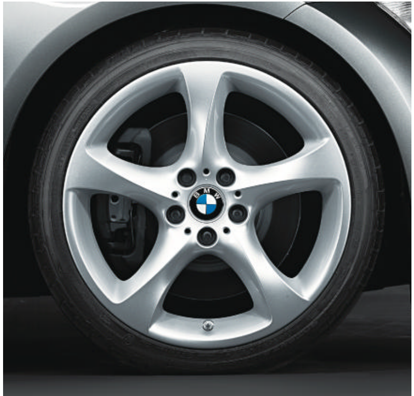
Lichtmetalen BMW wielen in sterspaak styling 230 , bredere banden achter, voor 8 J x 19 inch en bandenmaat 225/35 R 19; achter 9 J x 19 inch en bandenmaat 255/30 R 19, inclusief slotbouten.
