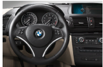
Met leder bekleed multifunctioneel sportstuur (diameter 369 mm), driespaaks, met geïntegreerde toetsen voor de bediening van bijvoorbeeld radio en telefoon (optie). Stuurwielverwarming voor multifunctioneel sportstuurwiel: verwarmt met een druk op de knop binnen korte tijd de stuurwielkrans; zeer aangenaam in de winter.
