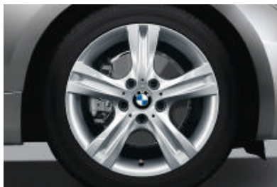
Lichtmetalen BMW wielen in sterspaak styling 262 met noodloopeigenschappen en bredere banden achter: vóór 7 J x 17 inch en bandenmaat 205/50 R 17, achter 7,5 J x 17 inch en bandenmaat 225/45 R 17.
