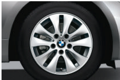
Lichtmetalen BMW wielen in V-spaak styling 229 met noodloopeigenschappen, 7 J x 16 inch, bandenmaat 205/55 R 16.
