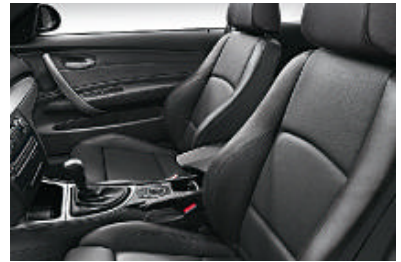
Sportzetels , voor bestuurder en voorpassagier. Bieden optimale zijdelingse steun dankzij elektrisch in breedte verstelbare rugleuning; overlangs-, zithoogte-, rugleuning-, zithoek- en bovenbeensteunverstelling zijn handmatig. Zetels hier afgebeeld in optioneel leder Boston Schwarz.
