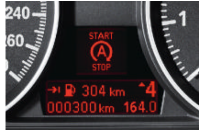
Auto Start Stop aanduiding. Toont in het info display wanneer de motor is afgezet door de Auto Start Stop functie, bijvoorbeeld voor een verkeerslicht of in een file. De aanduiding verdwijnt zodra de motor automatisch weer wordt gestart (voor alle viercilinder modellen; alleen i.c.m. handgeschakelde 6-versnellingsbak).
