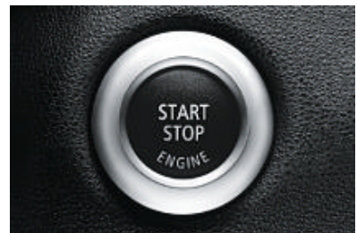
Start-/stopknop. Eerst wordt de afstandsbediening in de contactschakelaar geschoven. Daarna kunt u uw BMW met een druk op de knop starten of stoppen.
