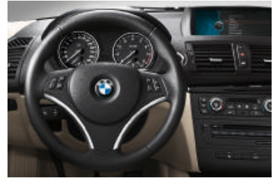
Met leder bekleed multifunctioneel sportstuur met geïntegreerde toetsen (diameter 369 mm), driespaaks. Met de toetsen kunnen tijdens het rijden bijvoorbeeld radio en telefoon (optie) worden bediend.
