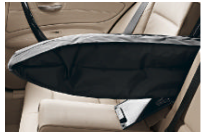
Skifoedraal : biedt de mogelijkheid om tegelijkertijd vier personen en vier paar ski's schoon en veilig in het interieur van de auto te vervoeren. Indien het skifoedraal niet wordt gebruikt, is het plaatsbesparend en onzichtbaar achter de middenarmsteun opgeborgen.
