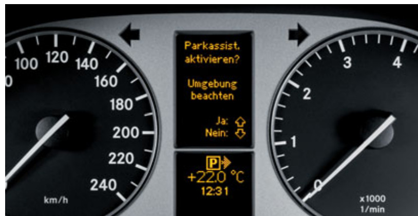
De aanduiding in het combi-instrument voor de actieve parkeerhulp.
