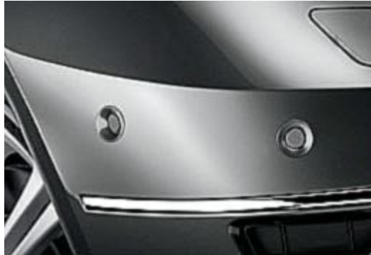
De afstandssensoren in de voor- en achterbumper zorgen ervoor dat er op de juiste manier wordt geparkeerd.
