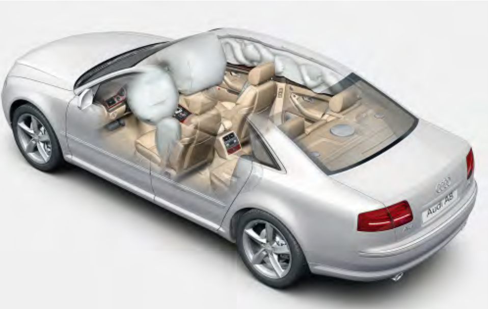
Airbags fullsize airbags voor bestuurder en voorpassagier; in twee stappen werkend; zijairbags voor/achter in de rugleuningen geïntegreerd; hoofdairbagsysteem
