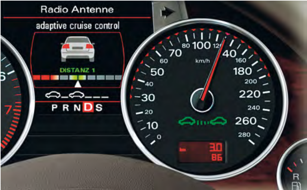
adaptive cruise control automatische afstandsregeling die werkt tussen de 30 en 200 km/h; een radarsensor detecteert voorliggers en houdt daarvan afstand door automatisch te remmen en accelereren; vier instellingen via de stuurhendel van de automatische snelheidsregeling
