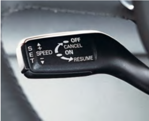
Automatische snelheidsregeling houdt elke snelheid vanaf circa 30 km/h vast, zover de motor dit toelaat, met actieve remingreep tijdens bijvoorbeeld bergafrijden; bediening via eigen stuurhendel
