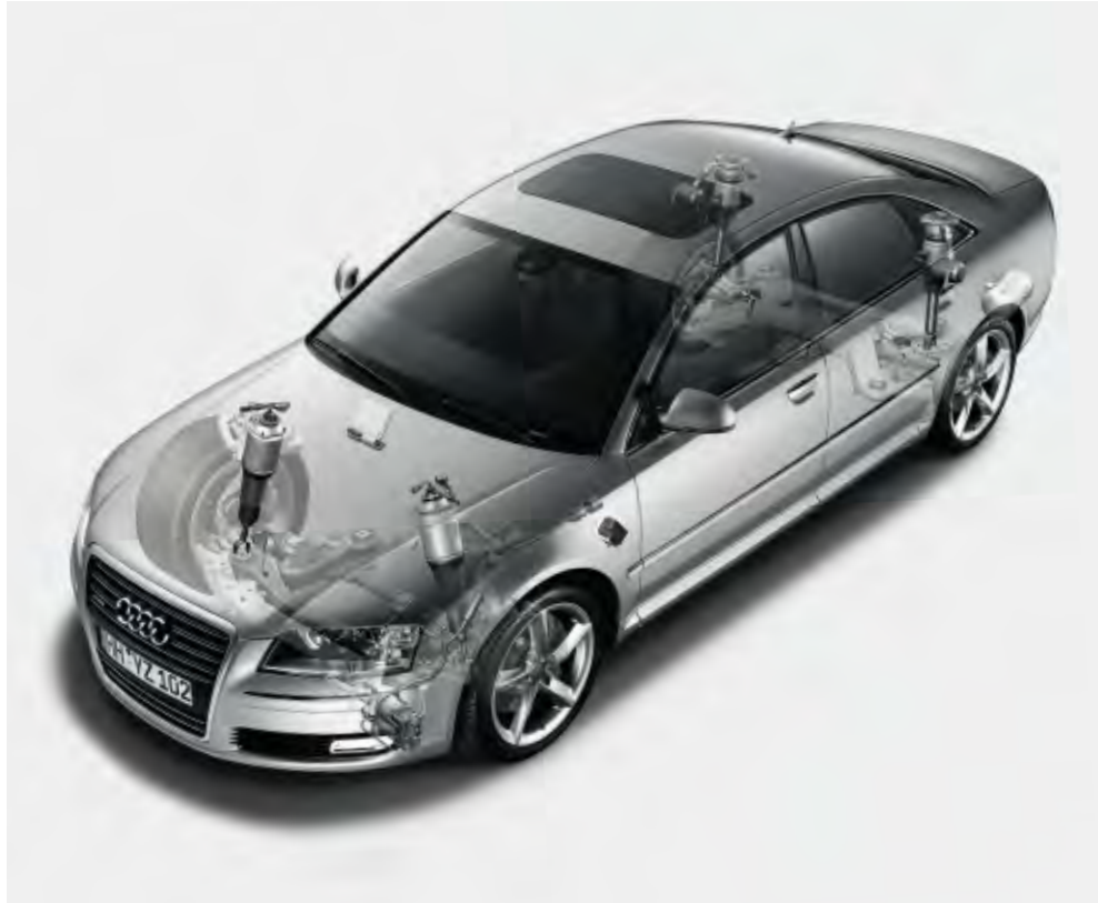
adaptive air suspension elektronisch geregelde luchtvering met traploos adaptief dampingssysteem rondom, regelt automatisch wagenhoogte en damping; vier standen (automatic, comfort, dynamic, lift), via MMI instelbaar; inclusief niveauregeling
