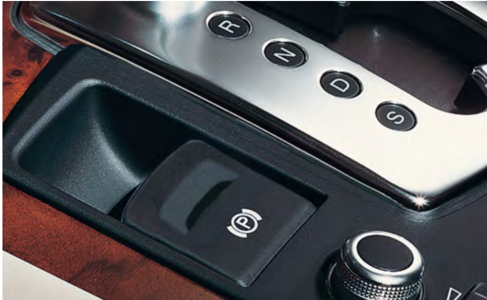
Elektromechanische parkeerrem met weghijhulp: parkeerrem bij stilstand, weghijhulp door automatisch uitschakelen bij het weggrijden en noodremfunctie op alle vier de wielen tijdens het rijden
