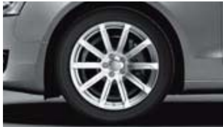
Gegoten lichtmetalen velgen Audi exclusive in 10-spaak design Maat 8,5 J x 18, banden 245/40 R 18. Van quattro GmbH
