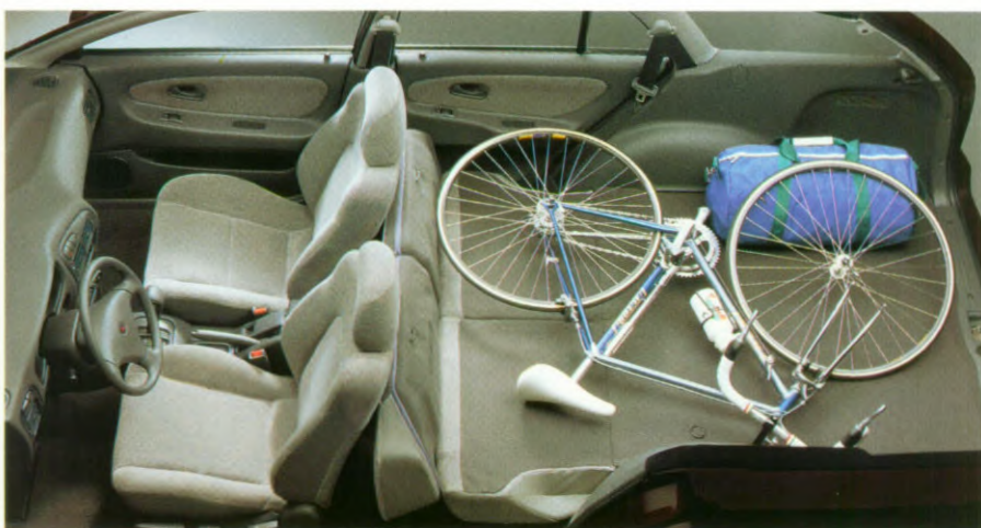
De rugleuning van de achterbank kan in z'n geheel, maar ook gescheiden worden neergeklapt. Zo ontstaat er een laadruimte van maximaal 740 liter, waarin met gemak de grootste ladingen kunnen worden vervoerd.
