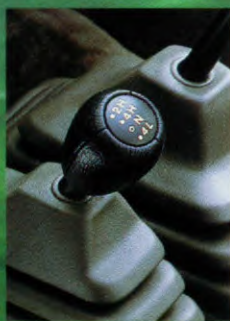
5-bak, voorwielaandrijving in- en uitschakelbaar via tussenbak met hoge en lage gearing.
