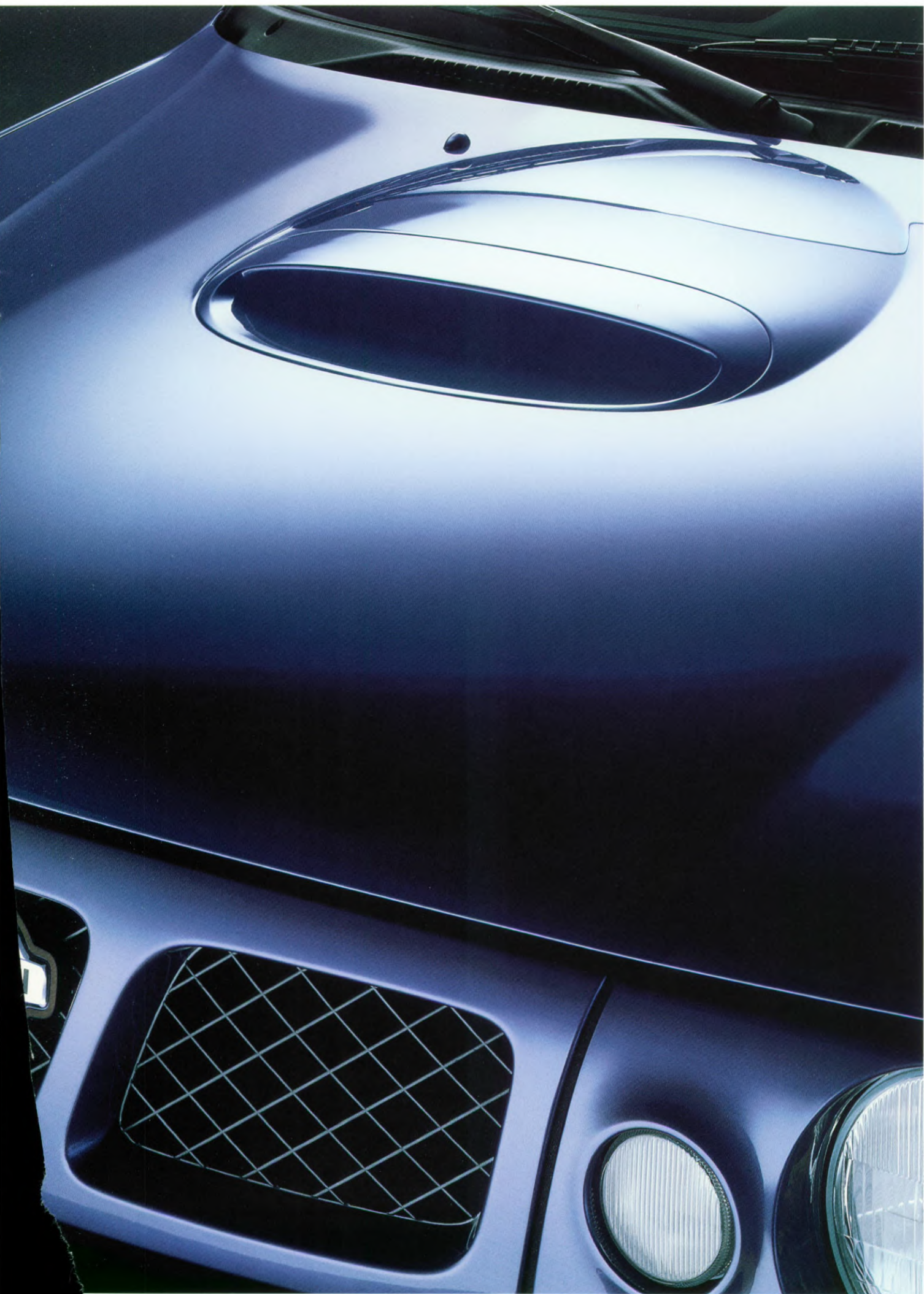
Luchtinlaat op de motorkap voor de intercooler van de Turbo dieselmotor.
