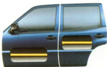
Stalen veiligheidsbalken in de zijportieren beschermen de passagiers bij aanrijdingen aan de zijkant.
