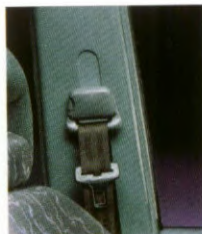
In hoogte verstelbare veiligheidsgordels vóór met gordelspanners.
