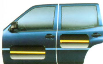
Stalen veiligheidsbalken in de zijportieren beschermen de passagiers bij aanrijdingen aan de zijkant.
