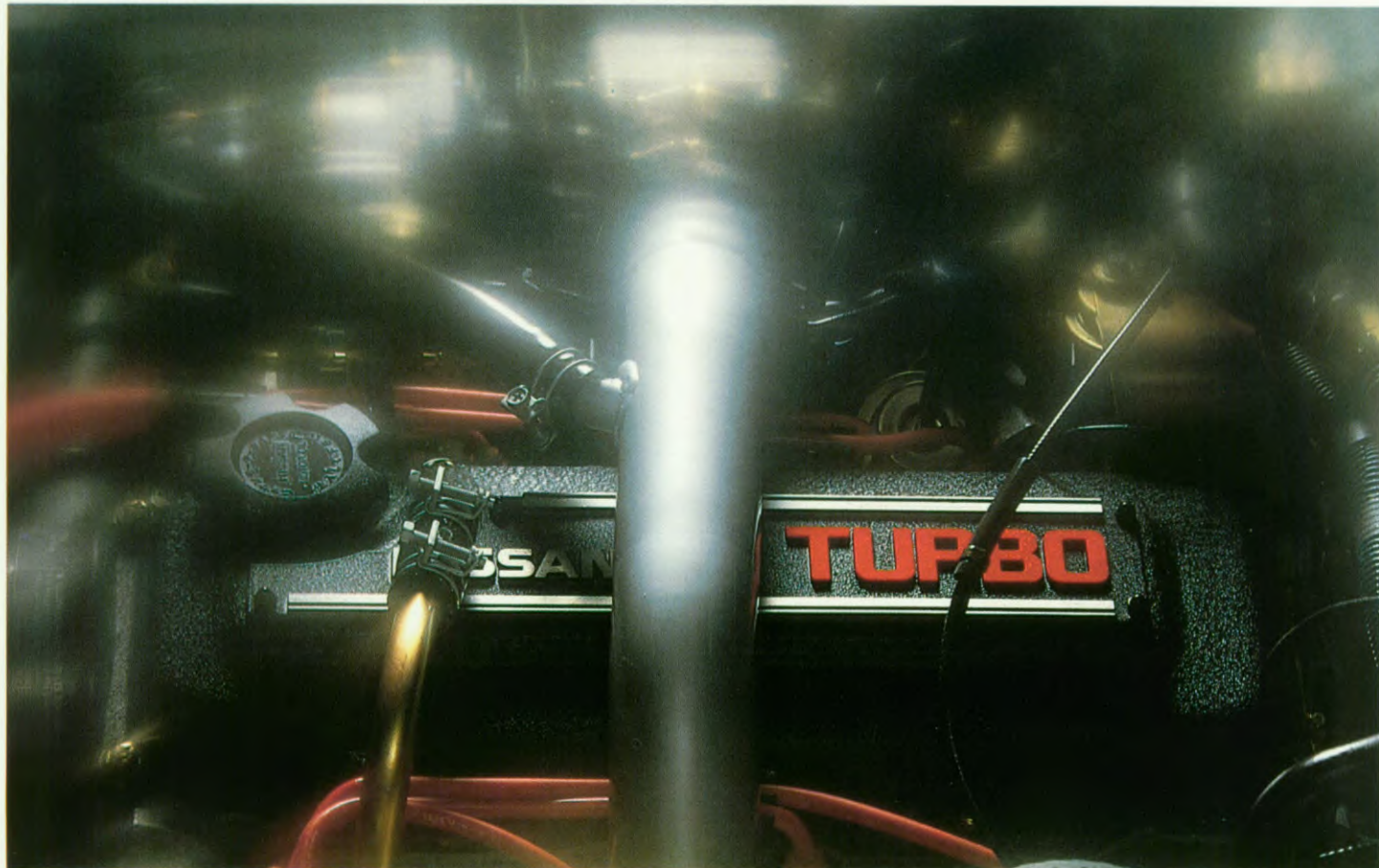
135 pk sterke 1.8 liter Turbo met bovenliggende nokkenas en elektronisch gestuurde brandstofinspuiting.
