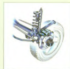
Op drie punten bevestigde voorwielophanging met starre as Schroefveren en stabilisatorstang.
