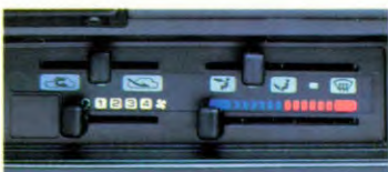
Full flow ventilatiesysteem met o.a. zijruitontwaseming en aanjager met 4 snelheden.
